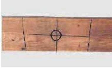
La position centrale repérée, on réserve une portion d'au moins 15 centimètres de part et d'autre du pivot (marques noires) qui sera la partie fixée sur l'axe et le système de frein de l'éolienne.
